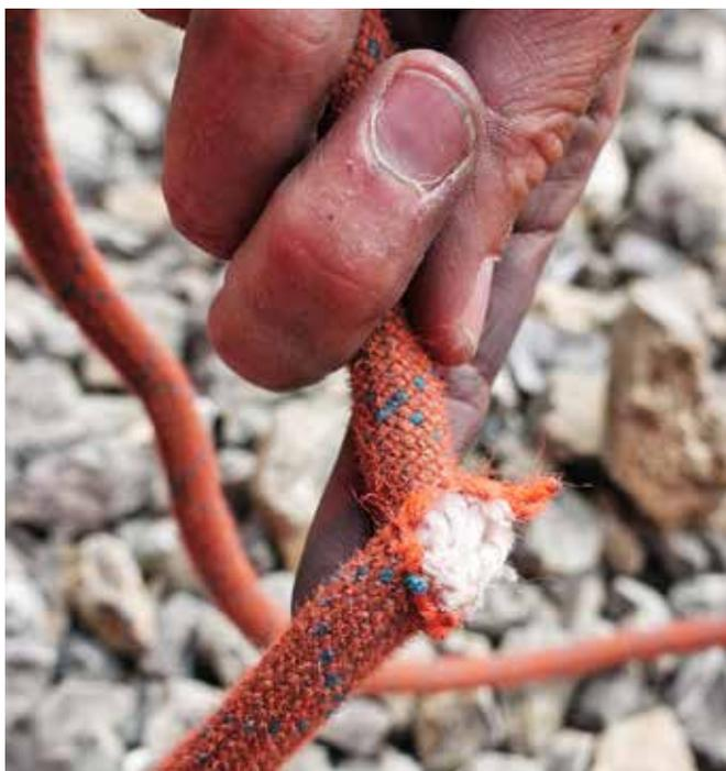
Abb. 2: Defekt des Seils nach Steinschlag.
