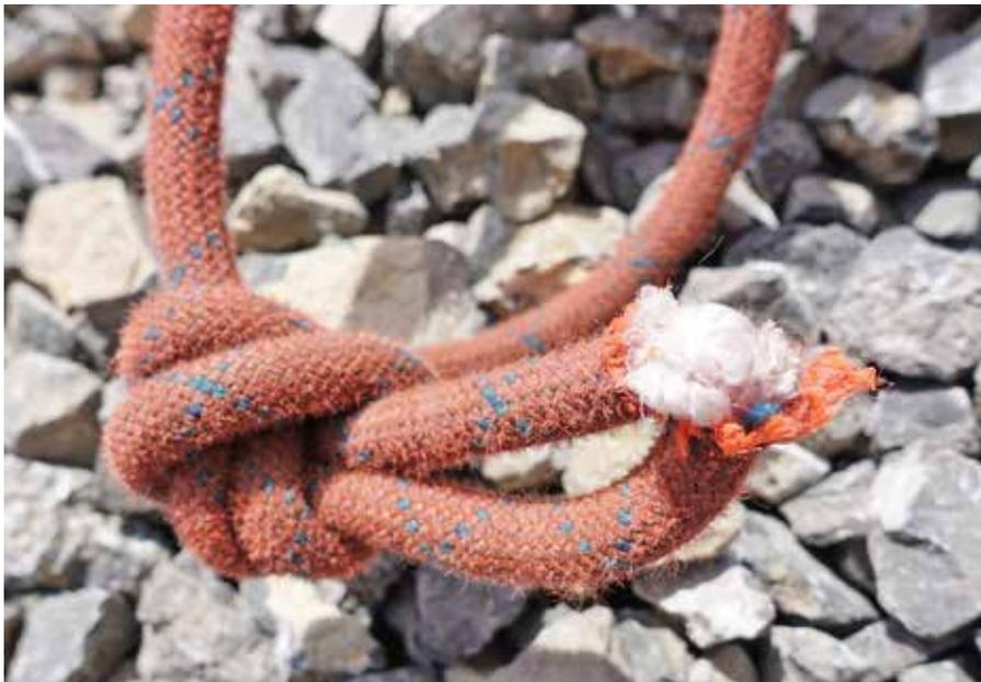
Abb. 1: Knoten im Bereich des Seildefektes, um diesen Teil des Seils von der Belastung auszunehmen.
