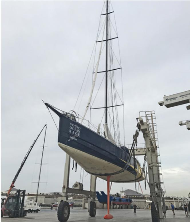
Der VO70 mit 4,5m-Schwenkkiel und 32m-Mast wird auf Lanzarote eingewässert
