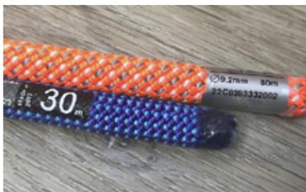
Abb. 1: Beschriftung von Seilenden mit den zutreffenden Seilcharakteristika
