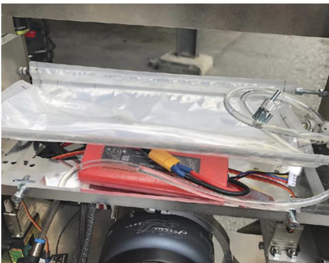
Der Düsenantrieb braucht Energie: Der leere Vacuum-Kerosin-Tank noch ohne Verschalung.
