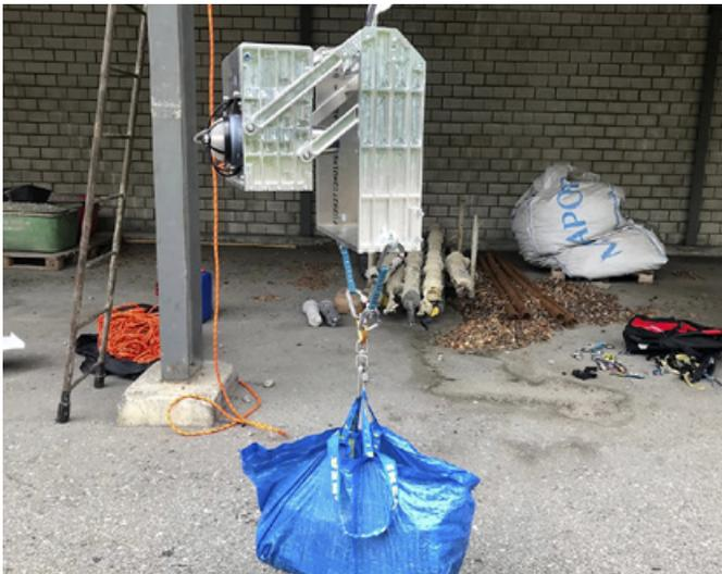
50 Kilo Zement ersetzen beim Prototyp-Test den Retter am Helikopterseil.
