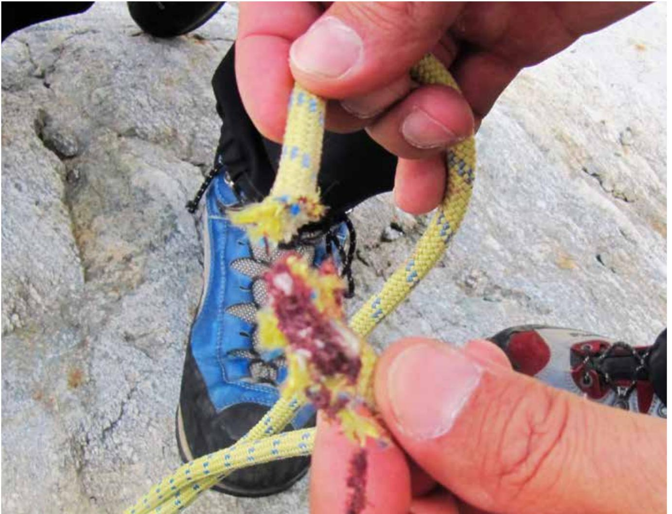
Oft unterschätzte Gefahr: Schmelzverbrennungen als Ursprung für gerissene Reepschnur.
